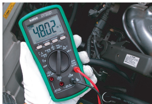
KT-2021デジタルサーキットテスターと660クランプアダプターを使用
