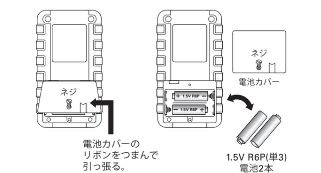
注：本器を長期間使用しない場合は電池を取り外してください。消耗した電池を内蔵したまま放置すると電解液が漏出して内部を腐食することがあります。
