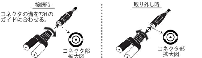
差し込んでから右方向に回しロックする。！左方向に回しロックを解除し引き抜く。
