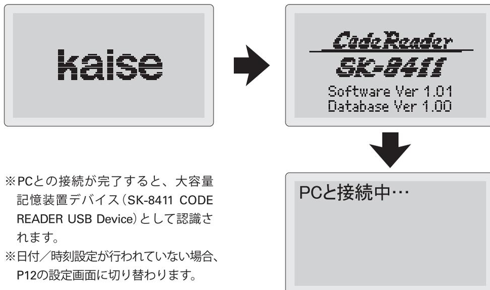
※PCとの接続が完了すると、大容量記憶装置デバイス (SK-8411 CODE READER USB Device) として認識されます。
