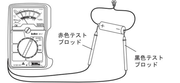
測定例：電池電圧の測定
