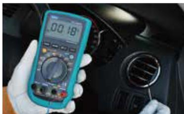
(例) エアコン吹き出し口の温度測定
